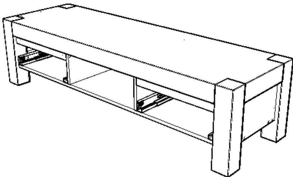
**ШАГ 5.** Прибить заднюю стенку гвоздями, предварительно проверив соответствие угла 90 градусам, путем замера диагоналей. Собрать ящики с помощью шкантов и евровинтов, вставить дно в пазы и прибить гвоздями. Прикрепить замки направляющих саморезами 3,5x16.
