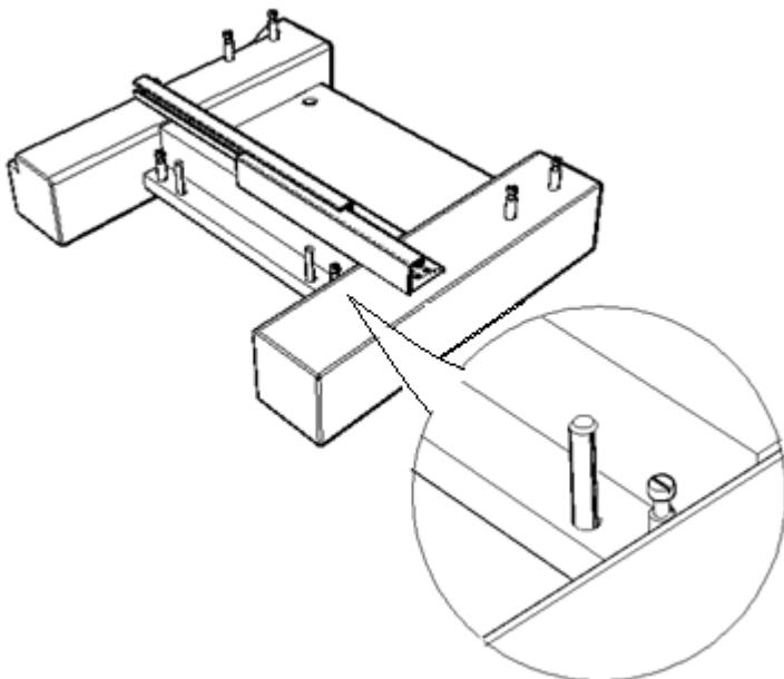
**ШАГ 2.** Собрать внутреннюю часть тумбы с помощью шкантов, эксцентриков и евро-винтов. Прикрутить направляющие саморезами 3,5x16.
