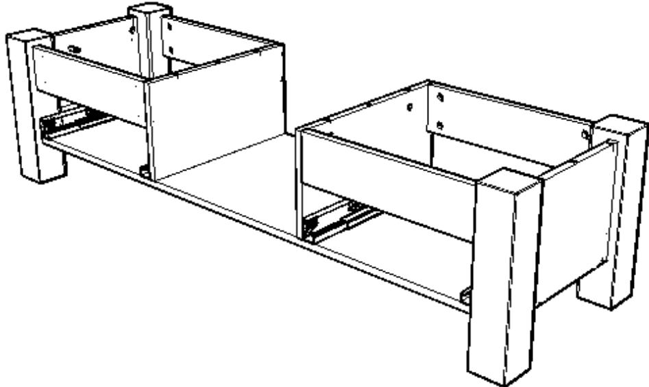
**ШАГ 4.** Установить крышку, с помощью шкантов и эксцентриков.
