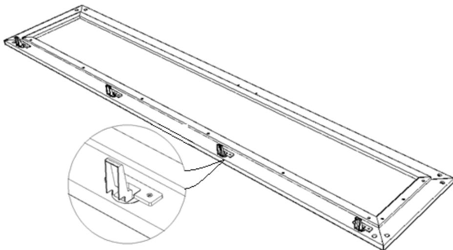
**ШАГ 6** Прибить заднюю стенку, предварительно выровняв каркас по уровню. Прикрутить планки петель саморезами 3,5х16 и установить подполочки. Один подполочник устанавливается в основании шкафа, в качестве ограничителя закрывания двери.
