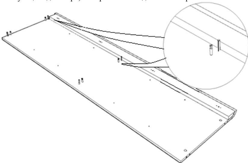
**ШАГ 2** Прикрепить к вертикальным деталям крышку и полку, с помощью эксцентров и шкантов.
