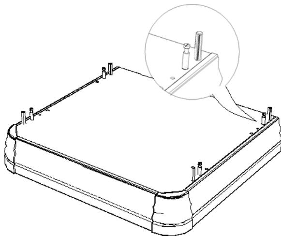
**ШАГ 4.** Прикрепить нижнюю часть шкафа к уже собранной части, с помощью эксцентриков и шкантов.
