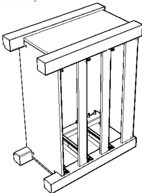
**ШАГ 4.** Установить крышку, с помощью шкантов и эксцентриков.
