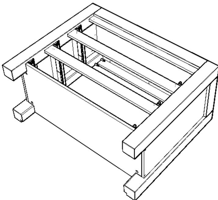
**ШАГ 5.** Перевернуть комод задней стороной вверх и прикрепить заднюю стенку, предварительно проверив соответствие угла 90 градусам, путем замера диагоналей. Затем собрать ящики с помощью шкантов и евровинтов, прибить дно гвоздями и прикрепить замки направляющих саморезами 3,5x16.
