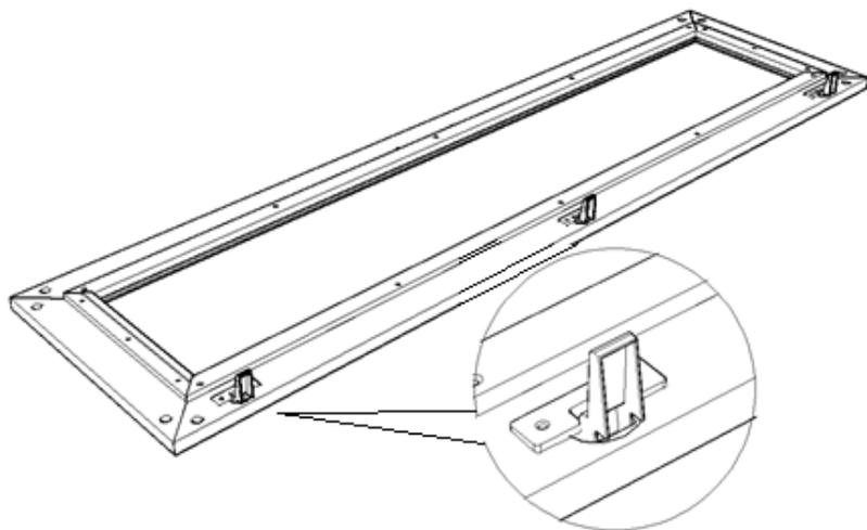
**ШАГ 6** Прибить заднюю стенку, предварительно выровняв каркас по уровню. Прикрутить планки петель саморезами 3,5х16 и установить подполочки. Один подполочник устанавливается в основании шкафа, в качестве ограничителя закрывания двери.
