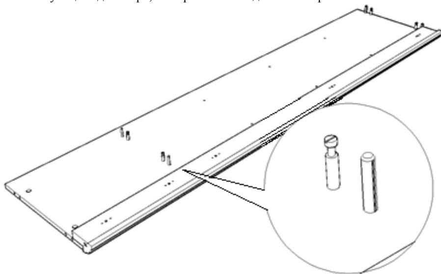
**ШАГ 2** Прикрепить к вертикальным деталям крышку и полку, с помощью эксцентров и шкантов.
