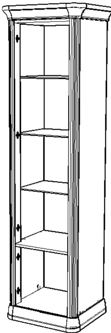
**ШАГ 8** Установить фасады и отрегулировать зазоры с помощью регулировочных винтов, которые находятся на петлях.
