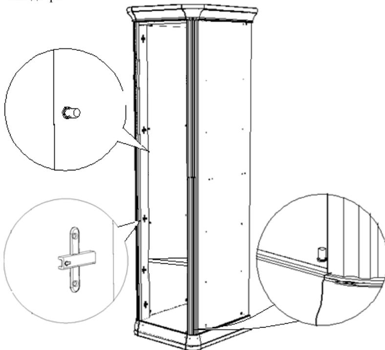
**ШАГ 7.** Приклеить зеркало к заднкой стенке на двусторонний скотч и установить полки.
