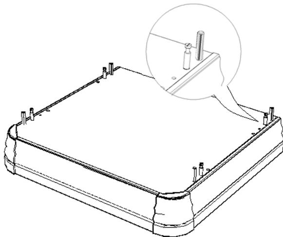
**ШАГ 4.** Прикрепить нижнюю часть шкафа к уже собранной части, с помощью эксцентриков и шкантов.
