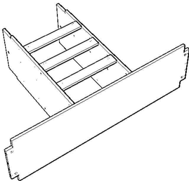
**ШАГ 3** Установить поперечные декоративные планки с помощью эксцентриков и шкантов.
