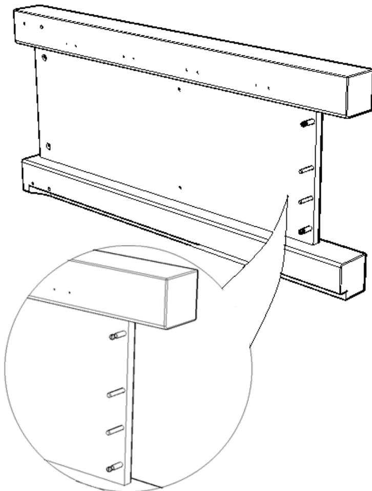
**ШАГ 2.** Соединить с помощью шкантов и эксцентриков внутренние детали комода
