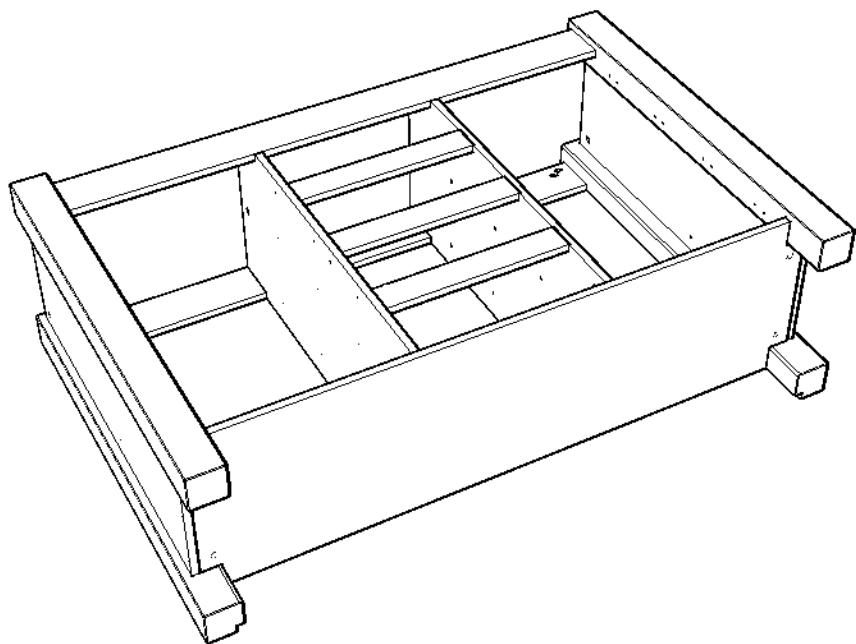
**ШАГ 4.** Установить ответные планки для петель, закрепив их саморезами 3,5x16 по мет., отталкиватели и направляющие. (Направляющие крепить в нижний ряд отверстий винтами 6,3x10,5).
