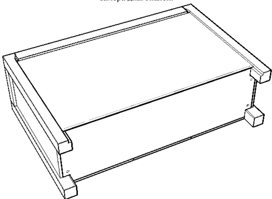
**ШАГ 8.** Собрать ящики с помощью шкантов и евровинтов, прибить дно гвоздями и прикрепить замки направляющих саморезами 3,5x16.
