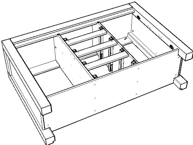
**ШАГ 7.** Перевернуть комод задней стороной вверх и прикрепить заднюю стенку, предварительно проверив соответствие угла 90 градусам, путем замера диагоналей.
