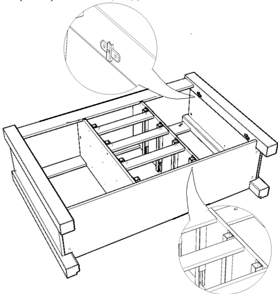
**ШАГ 5.** Вставить шканты и вкрутить эксцентрики в соответствующие отверстия на крышке.
