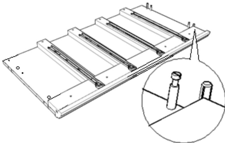
**ШАГ 2** Прикрепить к вертикальным деталям крышку, с помощью эксцентриков и шкантов.
