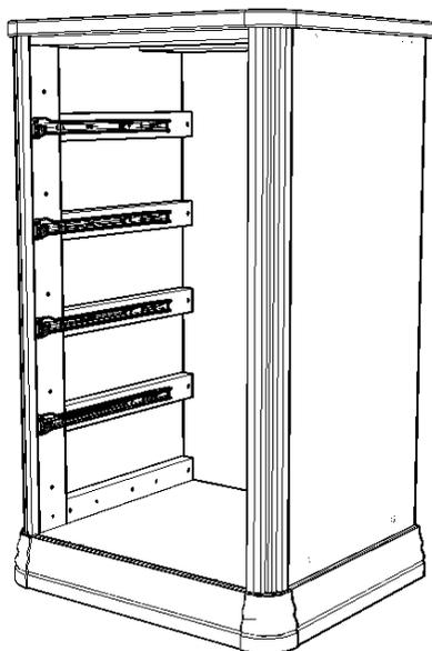
**ШАГ 6** Прикрутить нижние направляющие саморезами 3,5x16. По три самореза на каждую.
