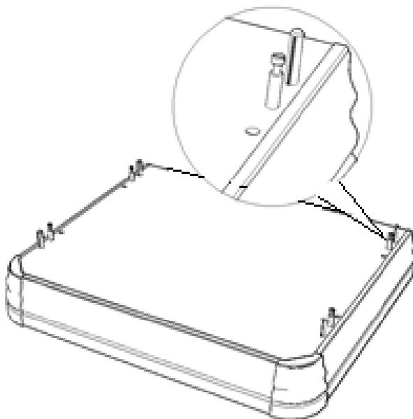
**ШАГ 4.** Прикрепить нижнюю часть комода к уже собранной части, с помощью эксцентриков и шкантов.
