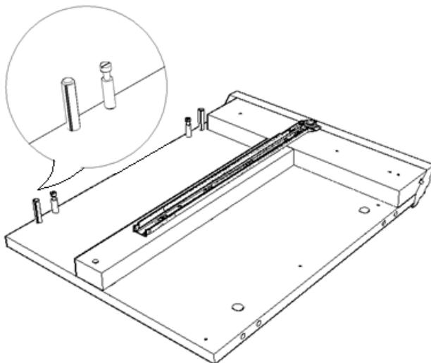
**ШАГ 2** Прикрепить к вертикальным деталям крышку, с помощью эксцентриков и шкантов.
