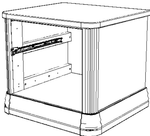
**ШАГ 6** Прикрутить нижние направляющие саморезами 3,5x16. По три самореза на каждую.
