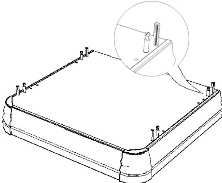
**ШАГ 4.** Прикрепить нижнюю часть тумбы к уже собранной части тумбы, с помощью эксцентриков и шкантов.
