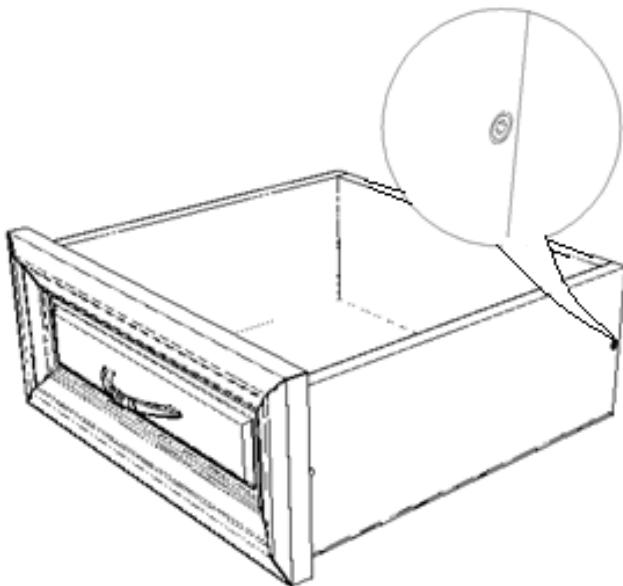
**ШАГ 8** Прикрутить направляющие к ящикам, саморезами 3,5x16. По три самореза на каждую.
