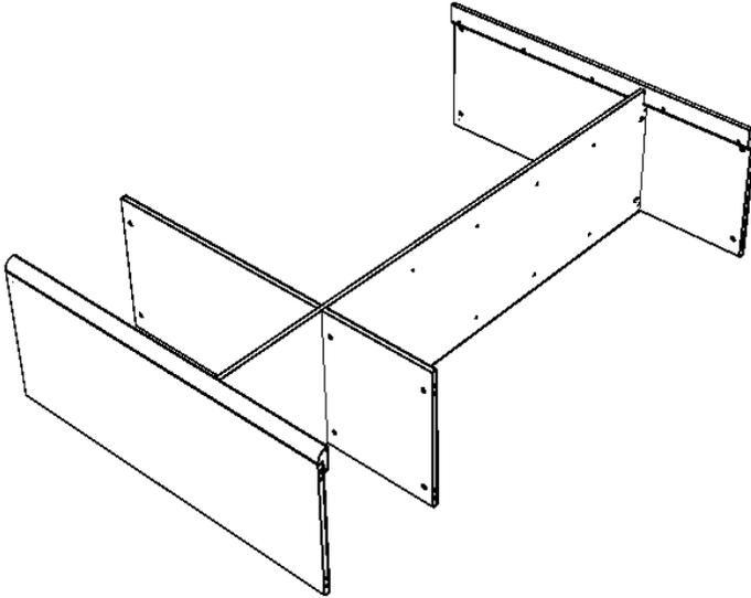
**ШАГ 2** Прикрепить боковины с помощью шкантов и эксцентриков, затем перевернуть шкаф и прибить заднюю стенку гвоздями, предварительно выровняв каркас шкафа, чтобы не было перекосов углов. Установить штангу, закрепив флянцы саморезами 3,5x16 и приклеить самоклеющиеся подкладки на нижнюю часть шкафа.
