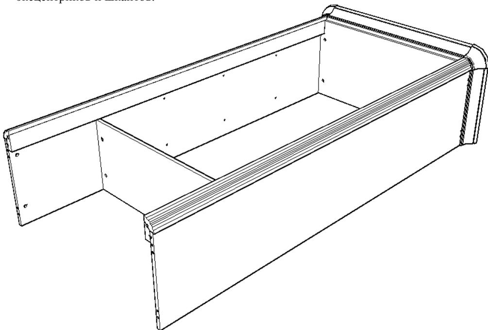
**ШАГ 3.** Вкрутить штоки эксцентриков и вставить шканты в нижнюю часть стеллажа.
