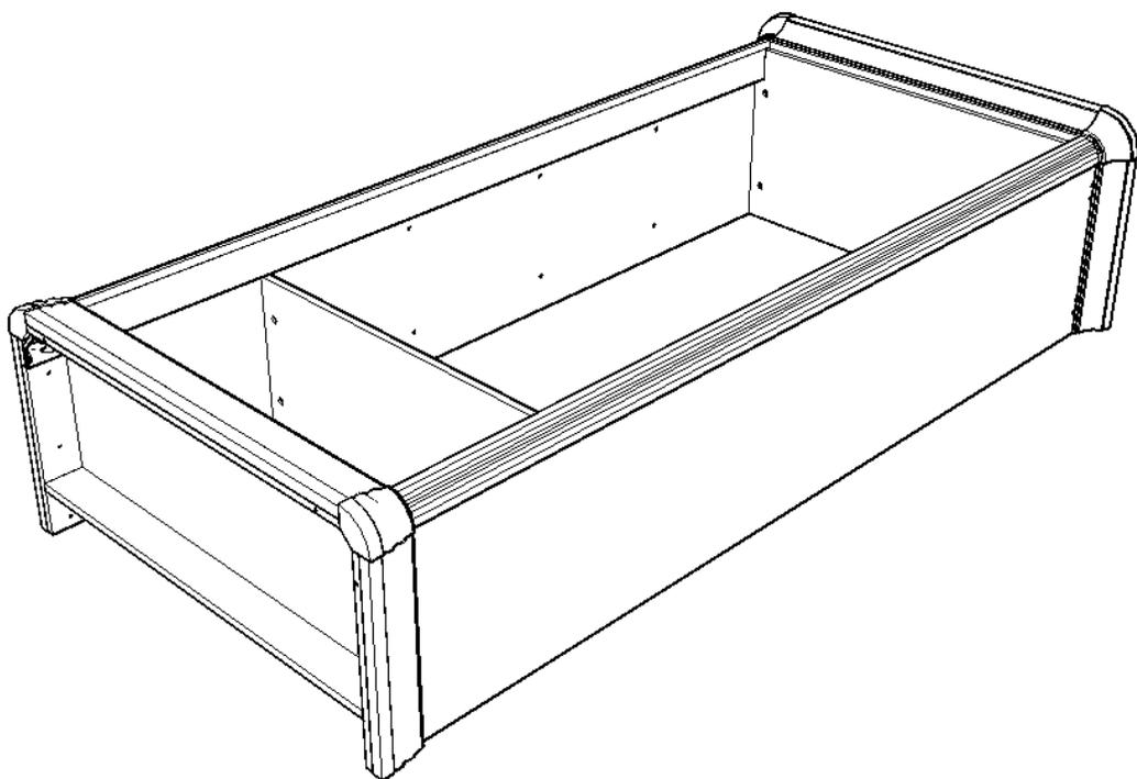
**ШАГ 5** Прибить заднюю стенку, предварительно выровняв каркас по уровню, установить подполочки и навесить полки.
