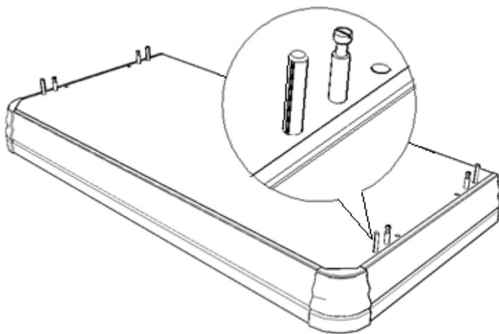
**ШАГ 4.** Прикрепить нижнюю часть стеллажа к уже собранной части, с помощью эксцентриков и шкантов.
