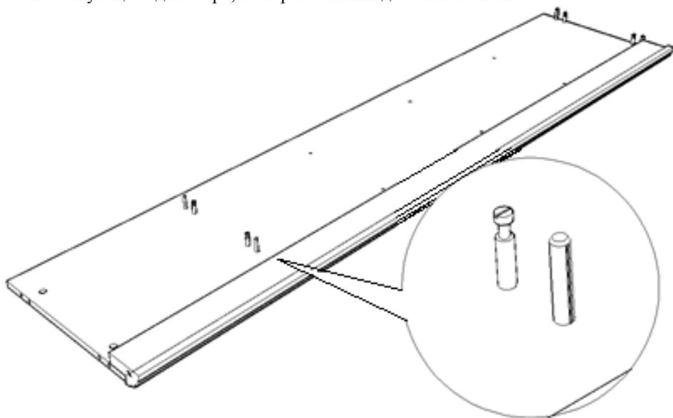
**ШАГ 2** Прикрепить к вертикальным деталям крышку и полку, с помощью эксцентриков и шкантов.
