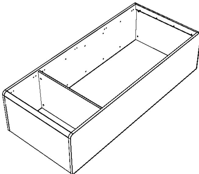
**ШАГ 2** Установить штангу, закрепив флянцы саморезами 3,5x16 и приклейте самоклеющиеся подкладки на нижнюю часть шкафа. Перевернуть шкаф и прибить заднюю стенку гвоздями, предварительно выровняв каркас шкафа, чтобы не было перекосов углов.
