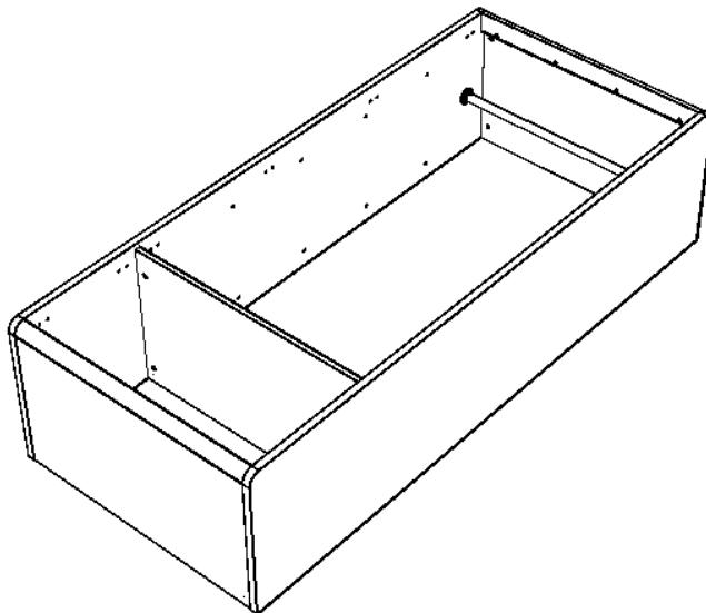
**ШАГ 3.** Установить шкаф на ровную поверхность, прикрутить планки петель саморезами 3,5x16 и навесить фасады. Установить полки с помощью подполочников.
